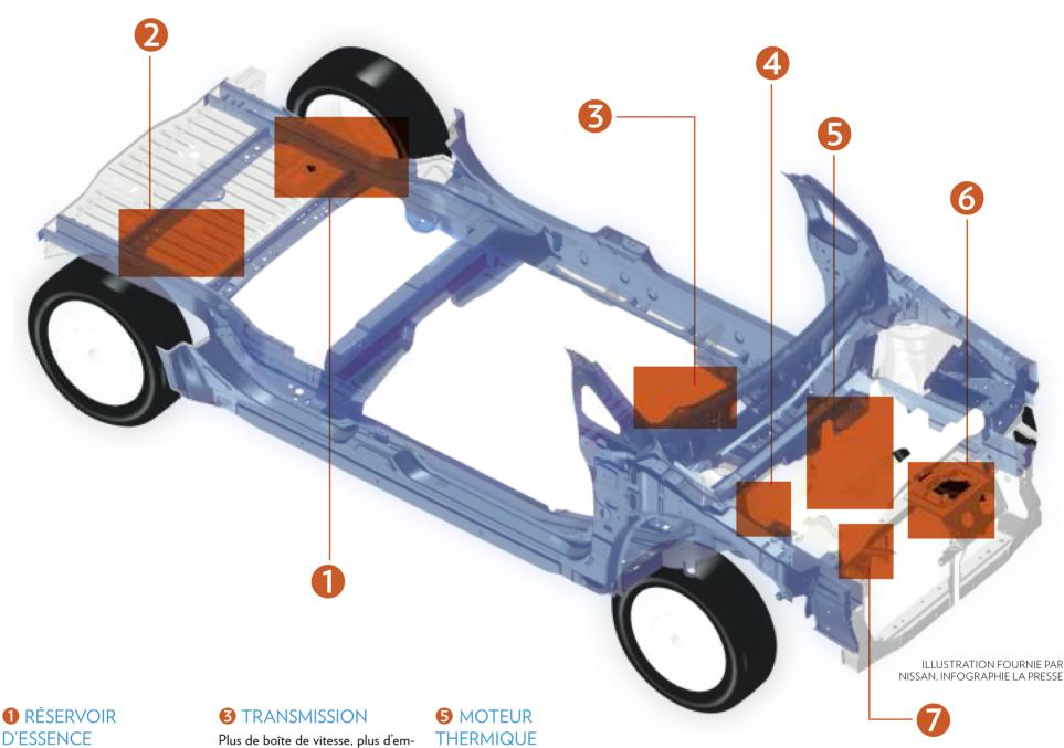
Plus de moteur thermique, plus d'essence, plus de réservoir. Le réservoir d'essence d'un véhicule classique est remplacé par le bloc-batterie à bord d'un véhicule électrique.
